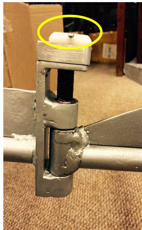
(b) Articulación y soporte para encoder (indicado en amarillo).
