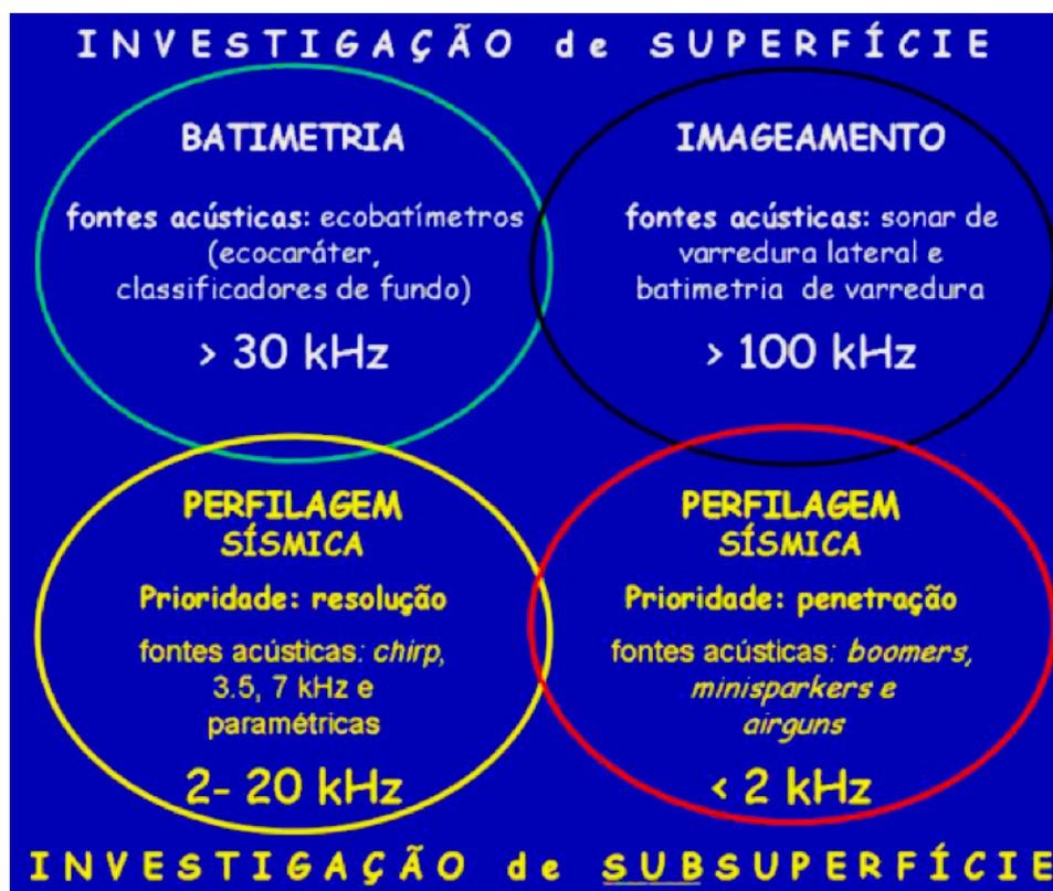
Figura 4 – Diferentes frequências de ondas elásticas para diferentes objetivos de informação a ser gerada, em ambientes de águas rasas. A batimetria e o imageamento são utilizados para um maior detalhamento da topografia do fundo, enquanto a perfilagem sísmica permite maior penetração. A perfilagem sísmica utilizando fontes de mais alta frequência resulta em maior resolução e menor penetração, comparado ao uso de fontes de mais baixa frequência (SOUZA, 2006).
