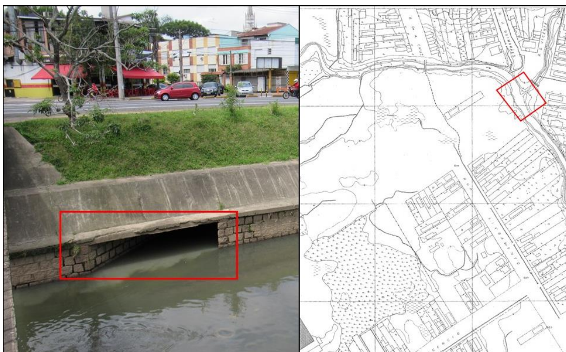
Figura 34: Mapa da desembocadura do Arroio São Vicente no Arroio Dilúvio antes da canalização. E fotografia identificando a desembocadura, após a canalização do Arroio São Vicente em subsuperfície. (Fonte: fotografia realizada em trabalho de campo e Mapa topográfico de Porto Alegre 1939-1941, Folha: XVI_2D; Escala 1:1.000)
