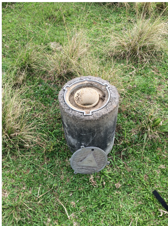
Foto 1 - Vista do Piezômetro PzMT-01.
