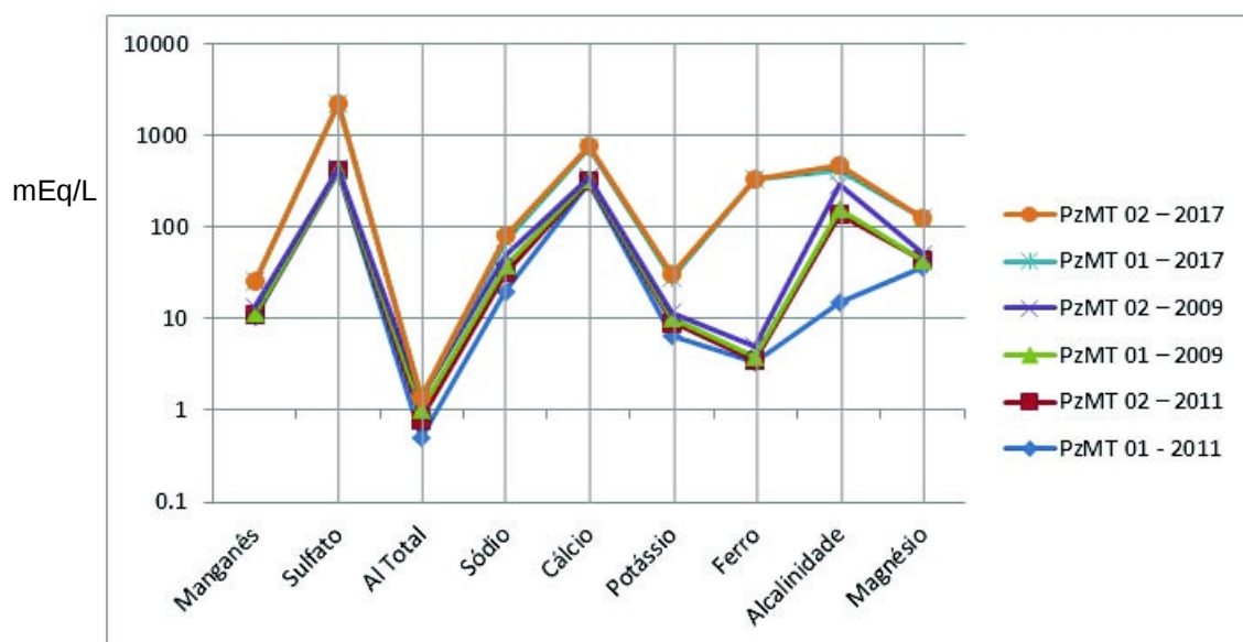
Figura 9 – Diagrama de Schoeller-Berkalof para as águas subterrâneas para os anos de 2009, 2011 e 2017
