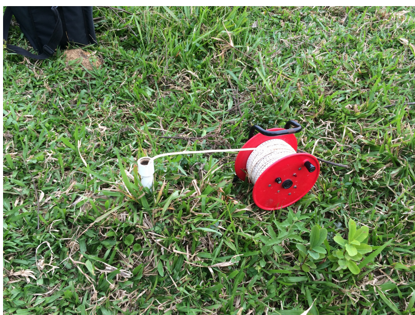
Foto 2 - Sonda de medir nível e vista do Piezômetro Freático
