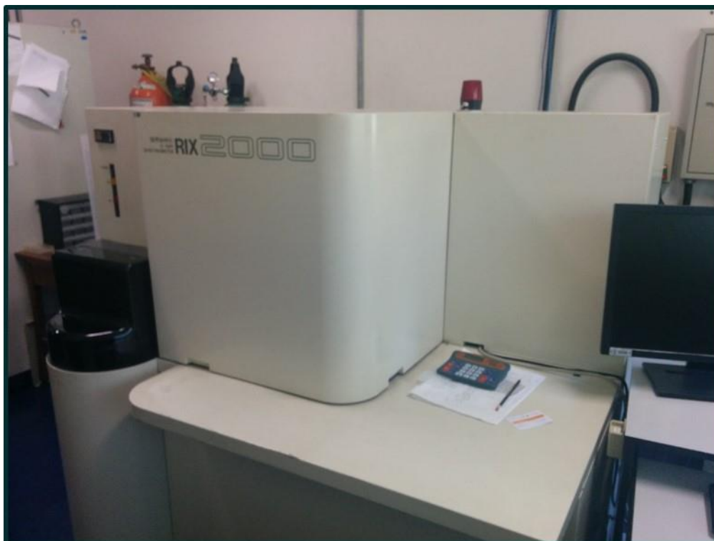
Figura 18: Equipamento Rigaku 2000 utilizado na técnica de Fluorescência de Raios X- Centro de Estudos em Petrologia e Geoquímica (CPGq) do Instituto de Geociências da UFRGS
