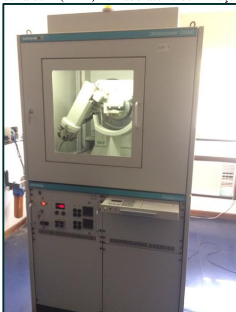
Figura 20: Difratorômetro Siemens modelo AXS D5000 Diffractometer utilizado durante as análises por difração de raios X (DRX) no Laboratório de Difração de Raios X do Instituto de Geociências da UFRGS.
