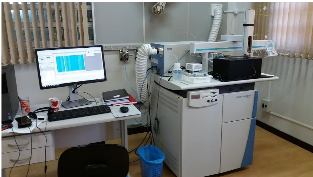
Fotografia 7 – Espectrômetro de Razão Isotópica Thermo Scientific, modelo Delta V, do Laboratório de Geologia Isotópica da Universidade Federal do Rio Grande do Sul
