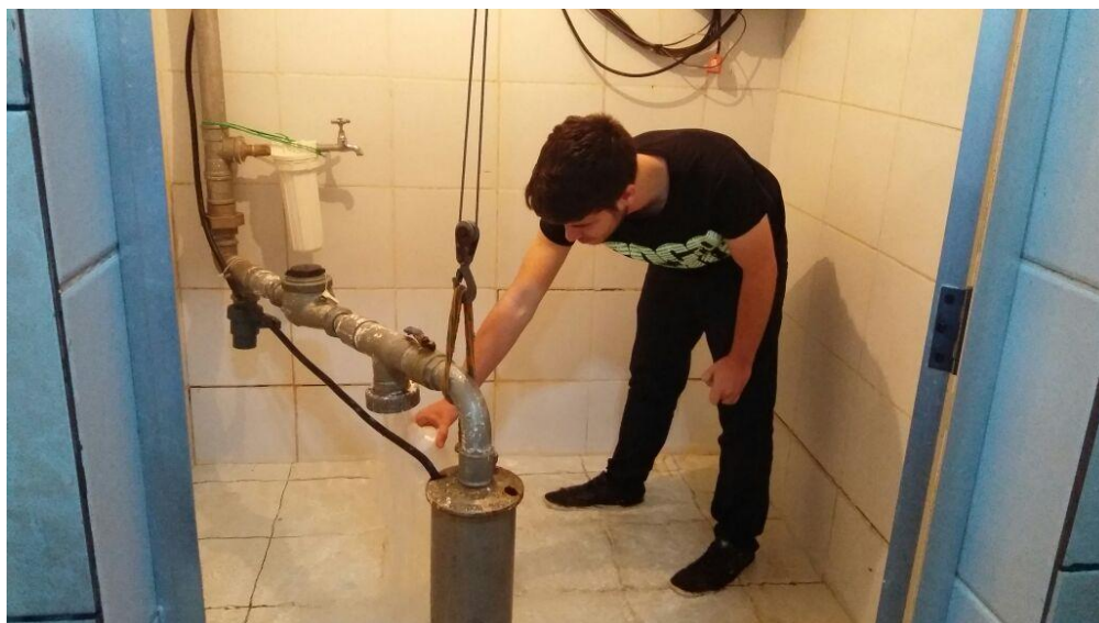
Fotografia 4 – Amostragem de água com a lavagem prévia dos frascos por três vezes com a própria água do poço
