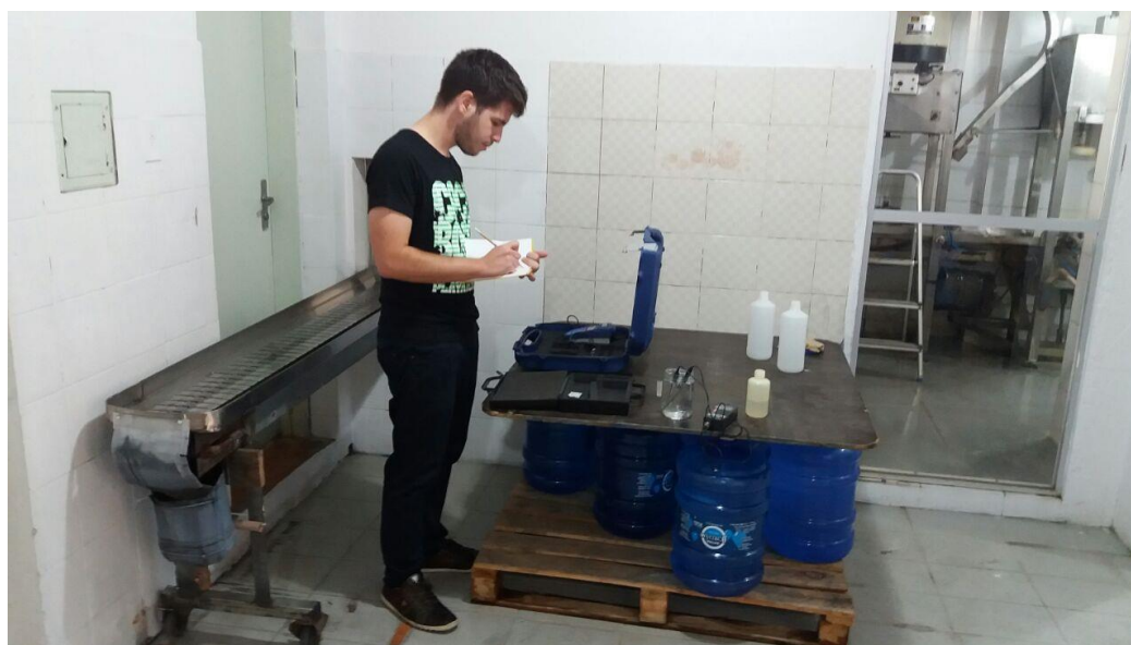
Fotografia 3 – Leitura in situ do pH, condutividade elétrica e temperatura
