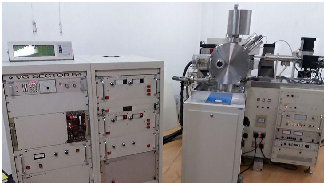
Fotografia 8 - Thermal Ionisation Mass Spectrometer, marca VG, modelo Sector 54, multi-coletor equipado com 9 coletores Faraday e 1 Daly do Laboratório de Geologia Isotópica da Universidade Federal do Rio Grande do Sul
