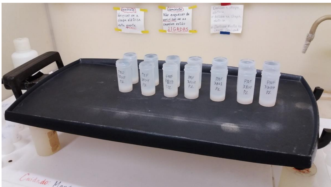
Fotografia 9 – Chapa elétrica utilizada na preparação de amostras isotópicas de Pb
