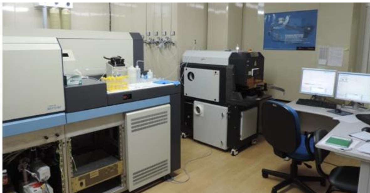
Figura 9: LA-MC-ICP-MS do LGI/UFRGS.
