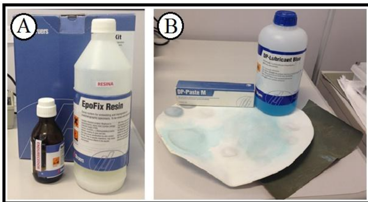
Figura 7: Materiais usados para resinagem da amostra. Sendo, (A) Resina e endurecedor; (B) Lixa, feltro, pasta diamantada e lubrificante.
