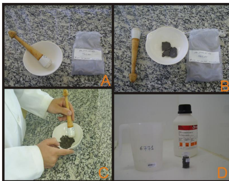
Figura VII. Separação do fragmento de rocha (A e B), trituração manual (C) e amostra pronta para adição de ácido (D).
