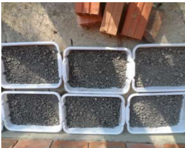
Figura 4.14: lodo anaeróbio incubado com cinzas, após o destorroamento.
