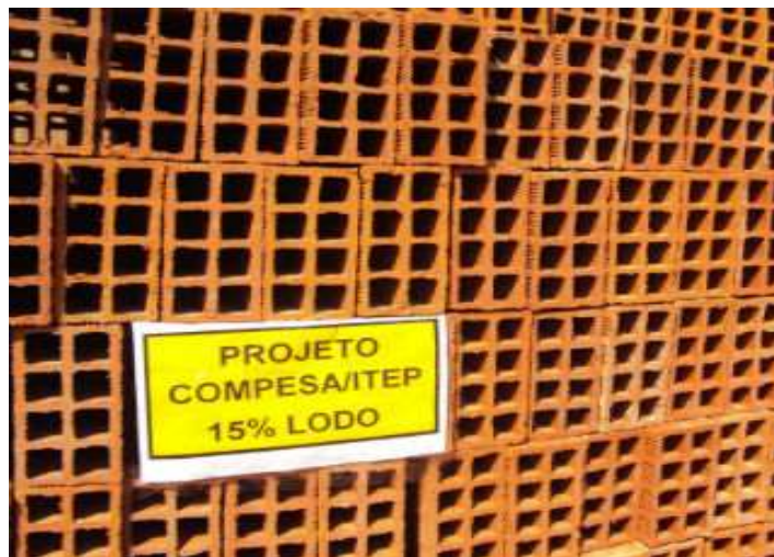
Figura 3.8: tijolos fabricados a partir de mistura de lodos.
