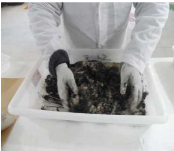
Figura 4.12: atividade de mescla do lodo anaeróbio desaguado com as cinzas.
