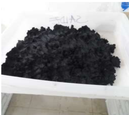
Figura 4.9: lodo anaeróbio de UASB em estado desaguado bruto.
