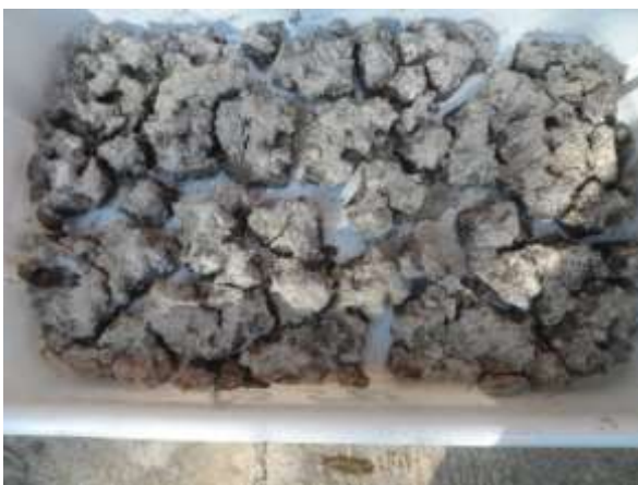
Figura 4.13: lodo anaeróbio incubado com cinzas, antes do destorroamento.
