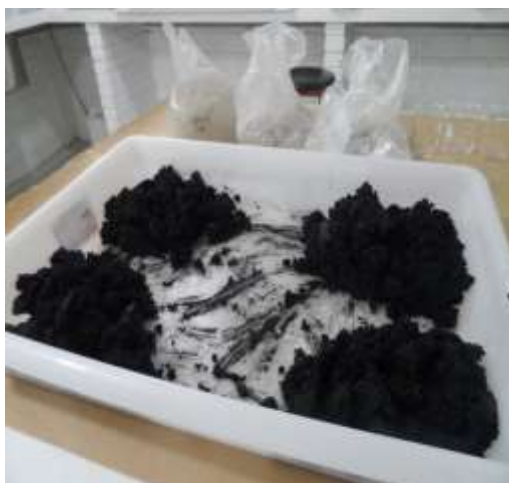
Figura 4.10: processo de quarteamento do lodo anaeróbio desaguado.
