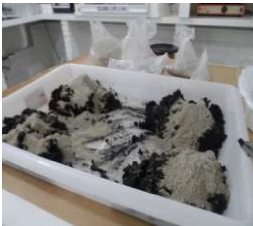
Figura 4.11: mistura do lodo anaeróbio desaguado com as cinzas.
