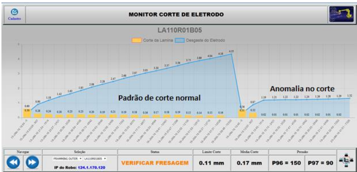
Figura 6.1 – Monitoramento do corte dos eletrodos por ciclo de fresagem
