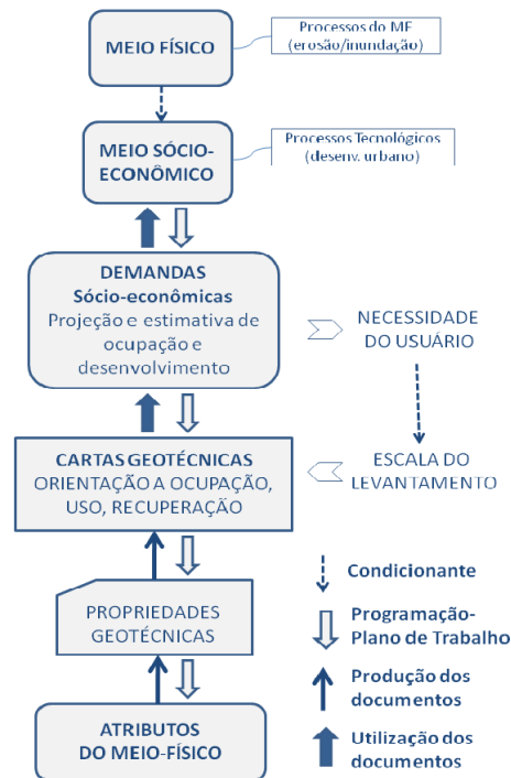
Figura 3.1: Sequência de procedimentos para elaboração da carta geotécnica de aptidão à urbanização (DINIZ & FREITAS, 2013)
