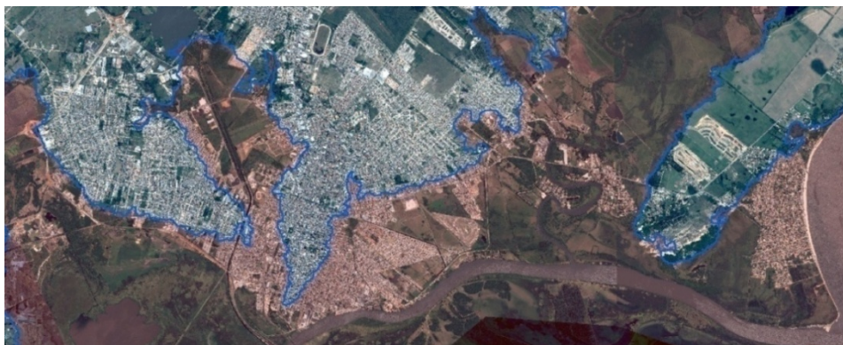
Figura 5.17: Parte da poligonal das planícies de inundação do Canal São Gonçalo, Arroio Pelotas, Canal Santa bárbara e Laguna dos Patos (em azul com fundo rosado) sobre recorte de Imagem do satélite Peiades do ano de 2014 para parte da área de estudo
