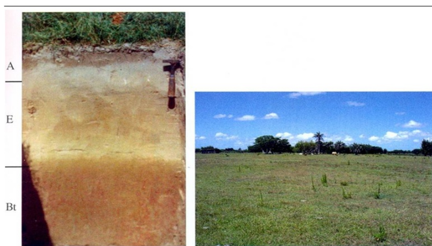
Figura 6.10: Perfil e paisagem de ocorrência típicos de Argissolos Vermelho-Amarelos da unidade Tuia (STRECK et al. , 2008)
