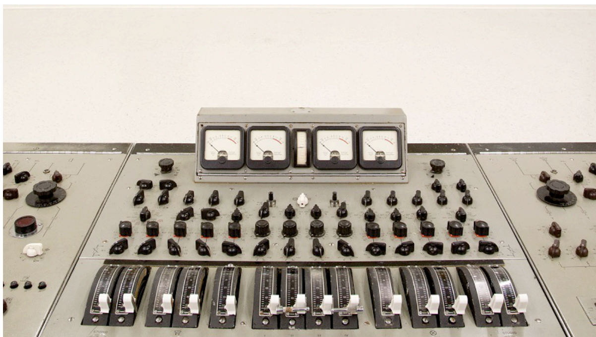
Console REDD .37, no estúdio Abbey Road em Londres, com quatro canais para gravação multitrack (fonte: https://vintageking.com/blog/2016/09/abbey-road-redd-37/ , acessado em 21/1/18)
