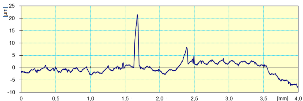
Figura 5.3 – Perfil de rugosidade da amostra 2w ( v_c = 240 \text{ m/min} ; f = 0,15 \text{ mm/rev.} ; a_p = 1,3 \text{ mm} ) com perceptíveis sinais de rebarbas e riscos que prejudicam o acabamento.
