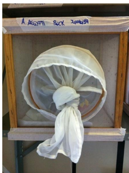
Figura 08 – Gaiola de criação de mosquitos com manga de manipulação
