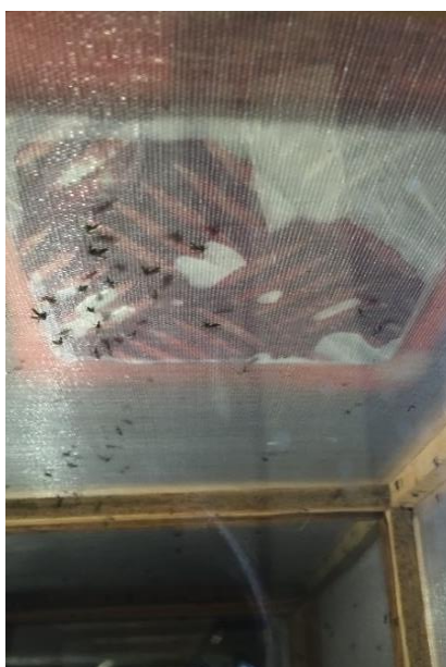
Figura 09 – protótipo de alimentador instalado no teto da gaiola.
