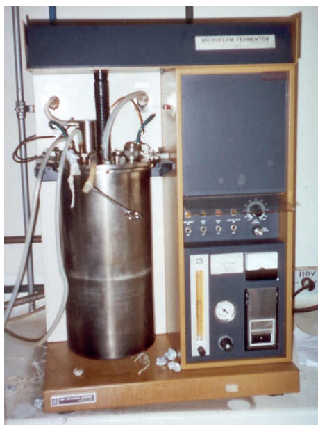
Figura 7. Biorreator utilizado. Reator New Brunswick – Microfermentor® Fermentor 14.
