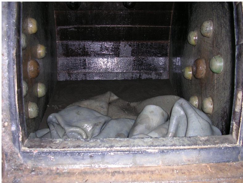
Figura 6. Fulão para experimentos de um curtume com pele em processo de depilação.
