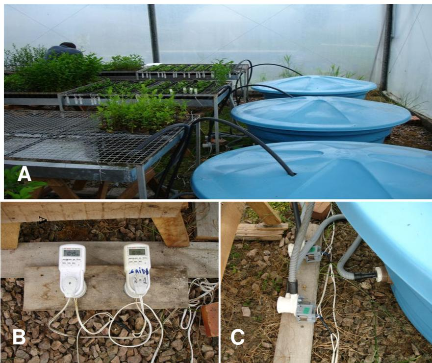
FIGURA 1. A) Sistema de subirrigação por capilaridade utilizado para fertirrigação de porta-enxertos cítricos: B) Temporizadores para acionar o funcionamento do sistema: C) Eletrobombas responsáveis pelo enchimento e retirada da água das bandejas EEA/UFRGS, Eldorado do Sul, RS, 2005.
