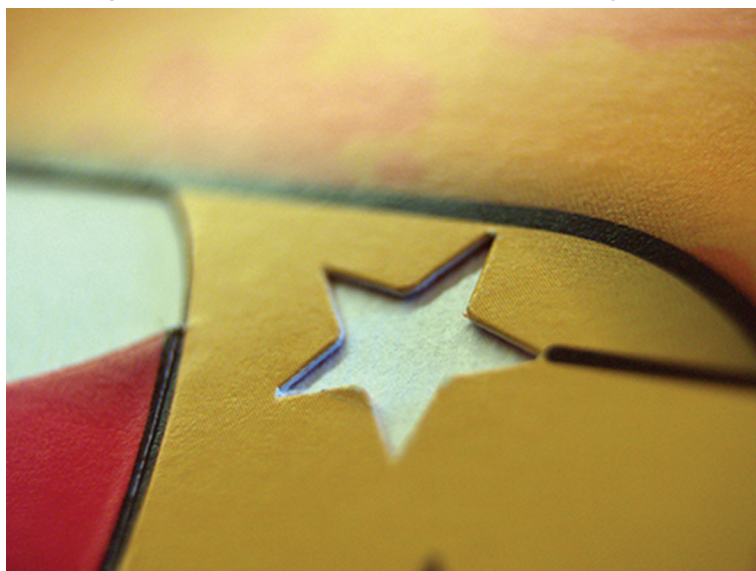
Figura 15: detalhe de recorte com faca especial
