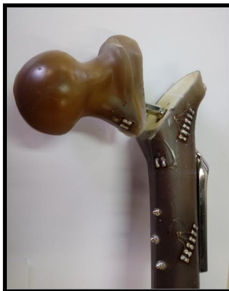
Figura 39 – (b) Imagens do ensaio da amostra 5. Região do fêmur onde ocorreu a fratura no componente do Pino Guia
