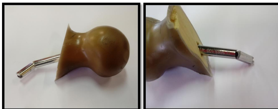
Figura 39 – (c) Imagens do ensaio da amostra 5. Pino Guia Fraturado.
