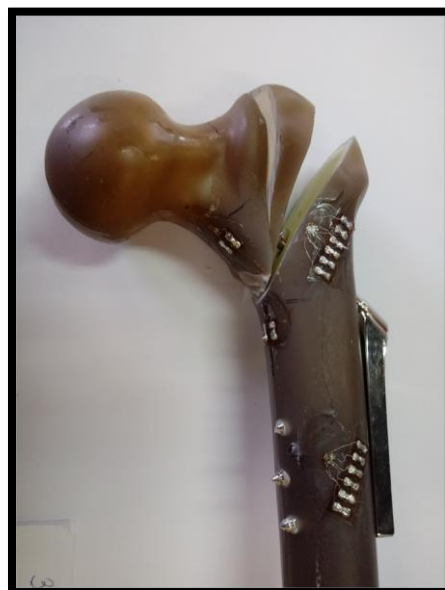
Figura 40 (b) – Imagens do ensaio da amostra 6. Região do fêmur onde ocorreu a fratura no componente do Pino Guia
