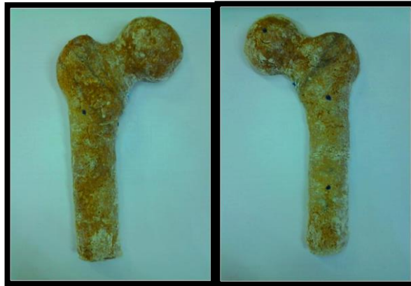
Figura 31 - Imagem dos gabaritos com a marcação dos pontos onde foram colocados os Strain Gauges
