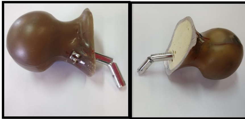
Figura 38 – (c) Imagens do ensaio da amostra 4. Pino Guia Fraturado Fonte: Elaborado pelo autor
