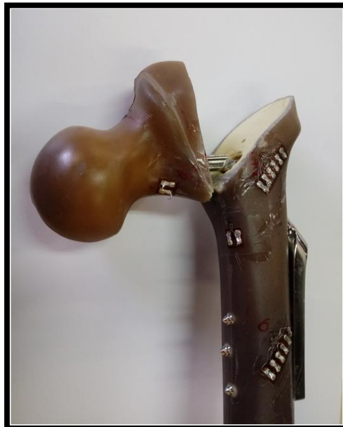
Figura 38 - (b) Imagens do ensaio da amostra 4. Região do fêmur onde ocorreu a fratura no componente do Pino Guia
