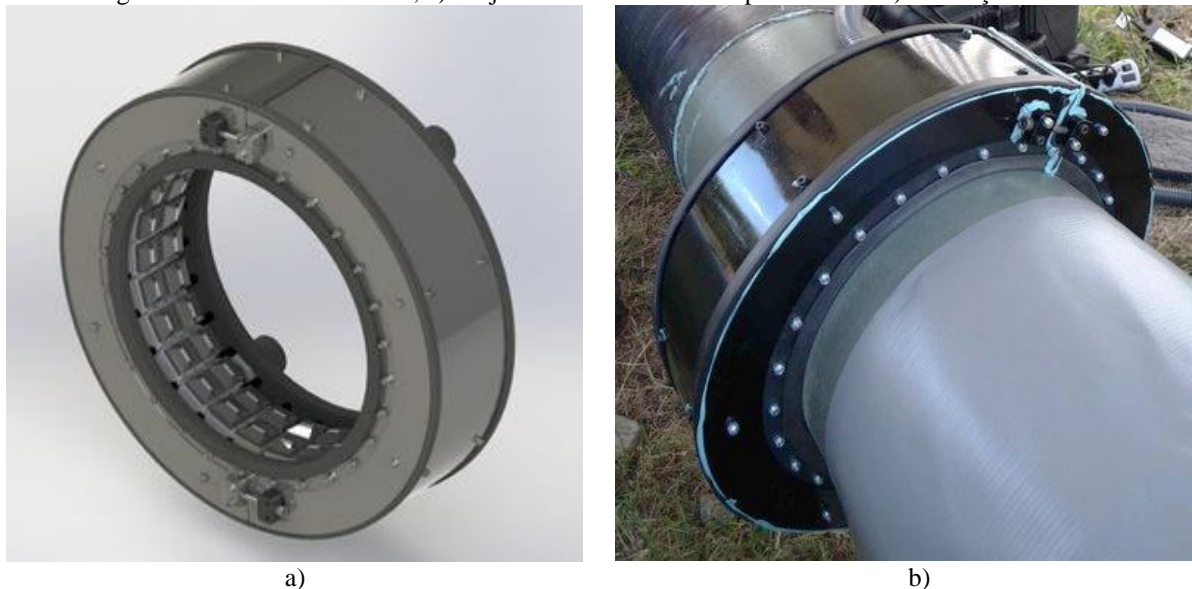
Figura 49 – Colar de sensores; a) Projeto em ferramenta computacional e b) instalação final.
