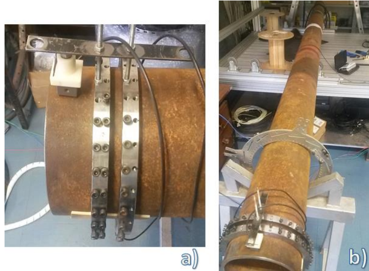
Figura 25 – Dispositivo de posicionamento do sensor a) Detalhe da fixação do sensor; b) posicionamento do tubo na bancada de interferometria.
