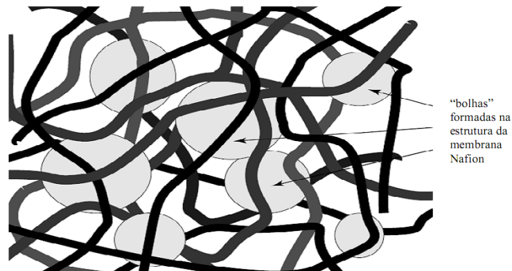
Figura 4- Desenho esquemático da microestrutura da membrana comercial Nafion.
