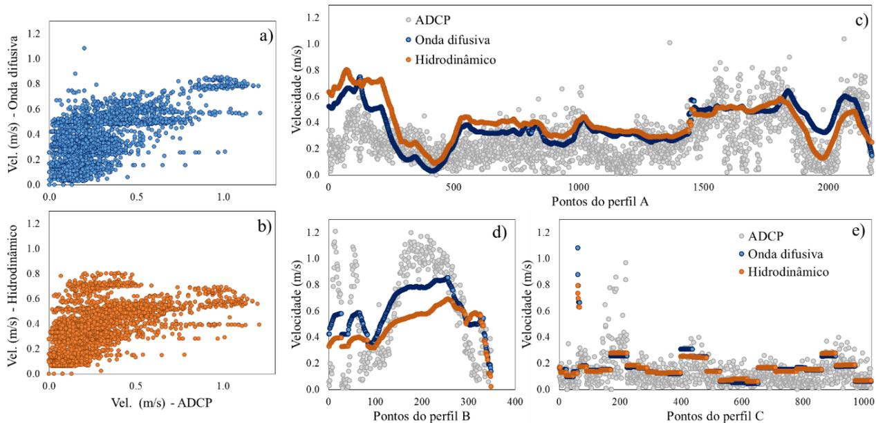
Figura 3. Velocidade prevista versus velocidade mensurada (ADCP) para os modelos Onda difusiva (a) e Hidrodinâmico (b). Velocidade no perfil A (a), B (b) e C (c).
