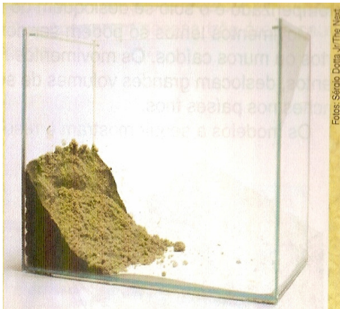
1- Construa uma “encosta” de argila nas laterais da caixa ou do tanque de vidro.
