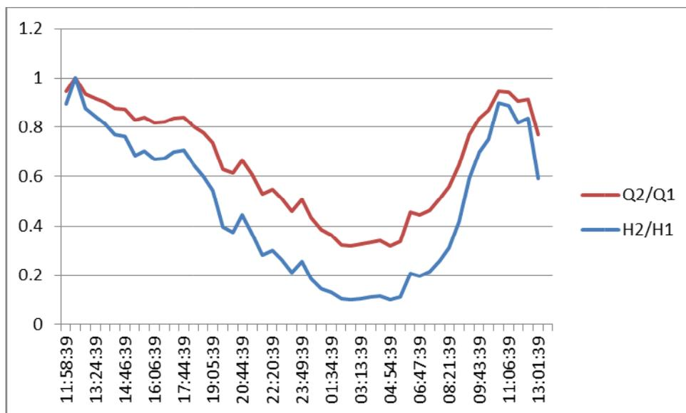
**Figura 3** - Variação da altura manométrica em relação à variação da vazão adimensional horária
