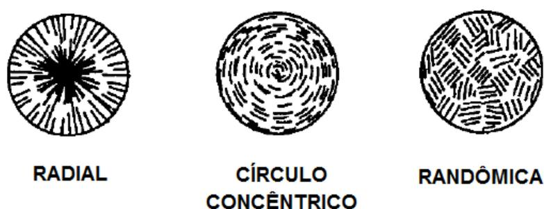
**Figura 11.** Modelos estruturais de fibras de carbono (cortes transversais) (adaptado).<sup>115</sup>
