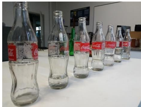
Figura 11 - Conjunto de garrafas iguais, com colunas de água de alturas diferentes
