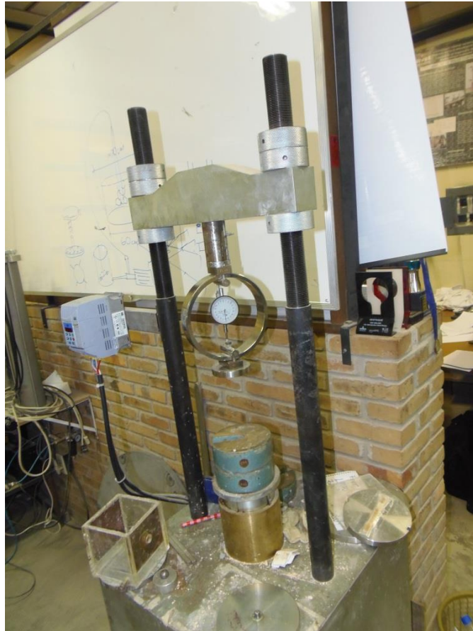
Figura 4.13: prensa utilizada para os ensaios de compressão simples.
