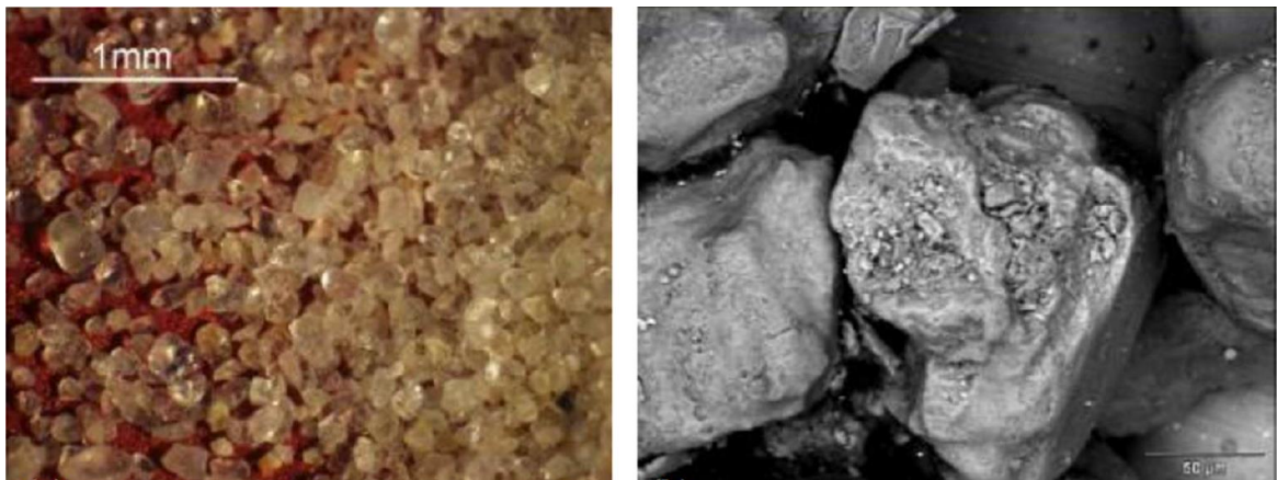
Figura 4.3: foto de microscopia eletrônica da areia de Osório ampliada 40 e 500 vezes. (MARQUES, 2009)
