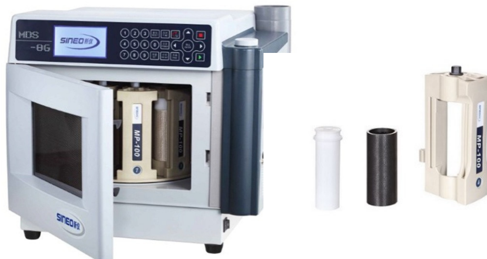
Figura 5.2 - Equipamento microondas com sistema de digestão/extração utilizado para a síntese das amostra e copo de teflon com suporte (Fonte: manual do equipamento SINEO SMART microwave).
