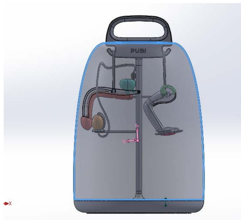
Figura 41 - Estudo de centro de massa no software de modelagem.
