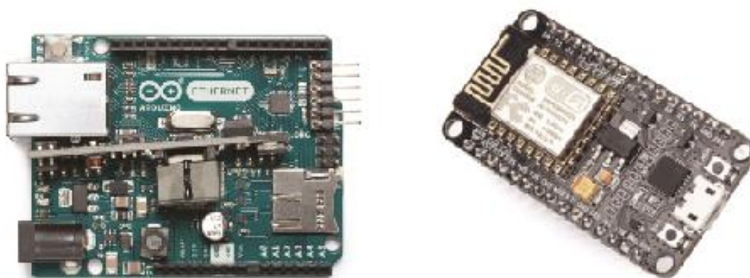
Figura 4 - Módulo Ethernet e NodeMcu
