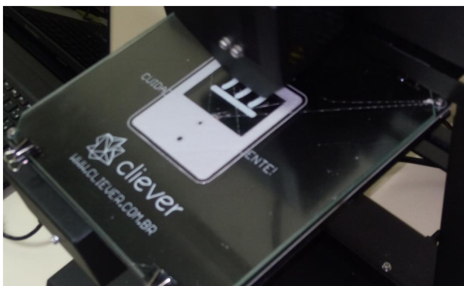
Figura 62 – Impressão em PLA da carenagem frontal do alarme sonoro
