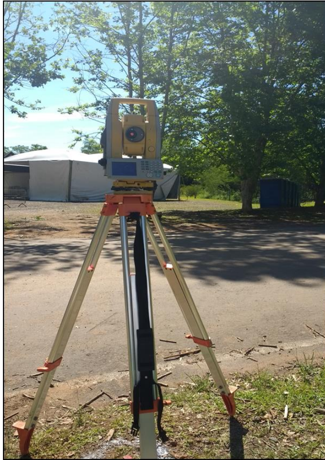
Figura 12- Estação Total no Ponto E1
