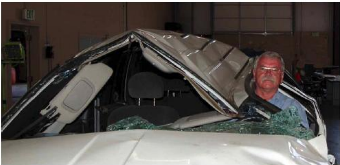
Figura 1.2 – Esmagamento do teto e deformação da coluna da porta que minimizam o espaço de sobrevivência [Grzebieta et al., 2007].
