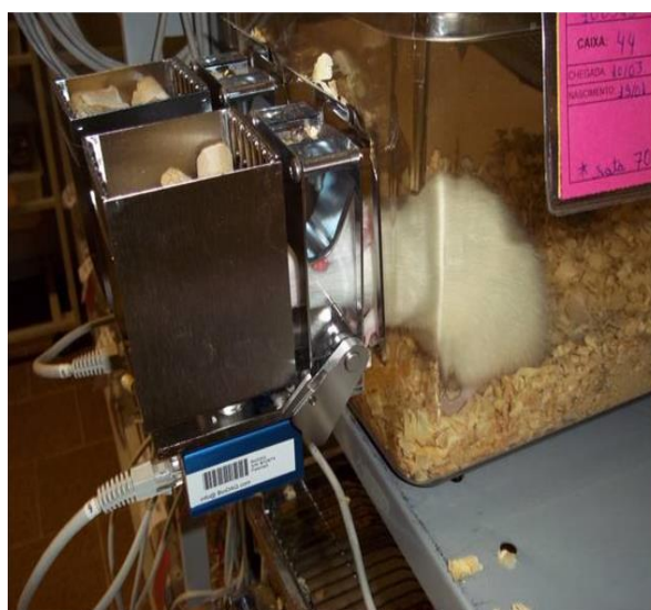
Figura 1: BioDAQ®. Cada caixa em que o animal se encontra está conectada a uma central (A) que envia as informações diretamente ao computador (B).
