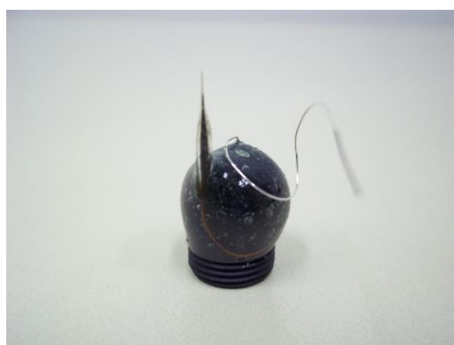
Figura 4: Eletrodo de fibra de carbono utilizado para a realização da cronoamperometria.
