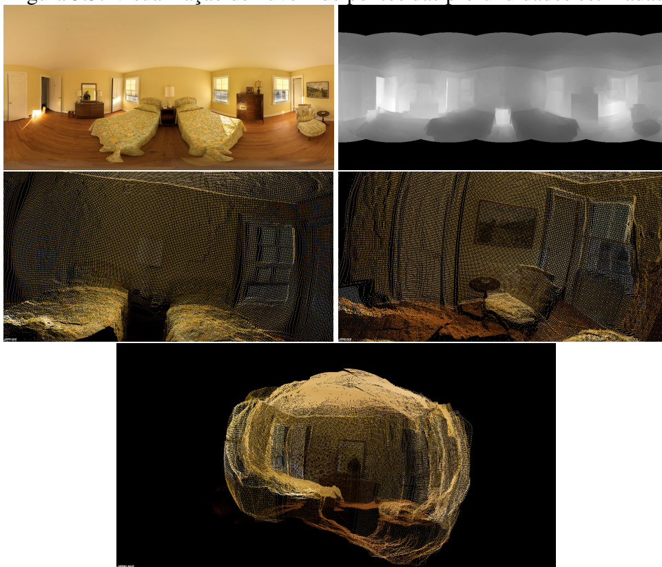
Figura 5.3: Visualização de nuvem de pontos das profundidades estimadas
