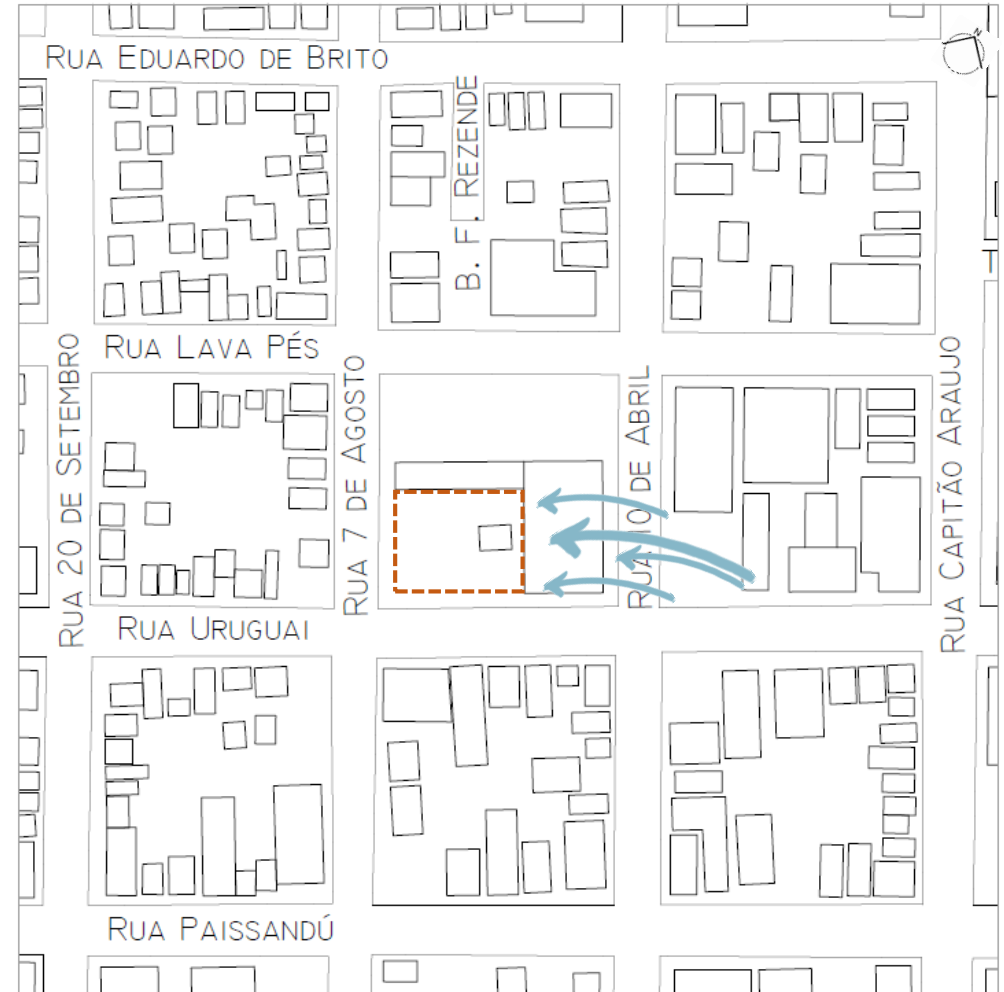
ESC: 1/2500 FIGURA 05 – Mapa de incidência de ventos Fonte: Dados coletados e graficados pela autora
