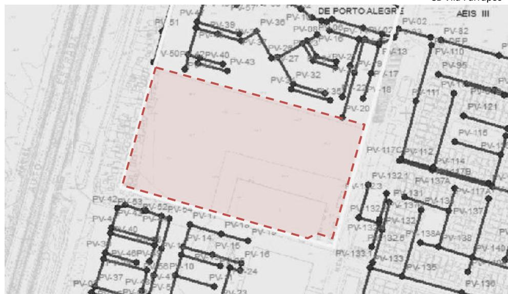
— Dutos de Esgoto ● Caixas de Esgoto Mapa da Rede de Esgoto Cloacal
