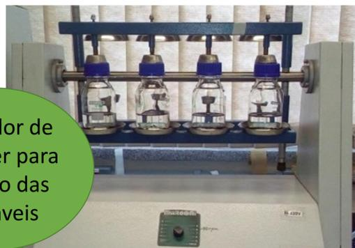
Agitador de bancada refrigerado para as isothermas de adsorção.
