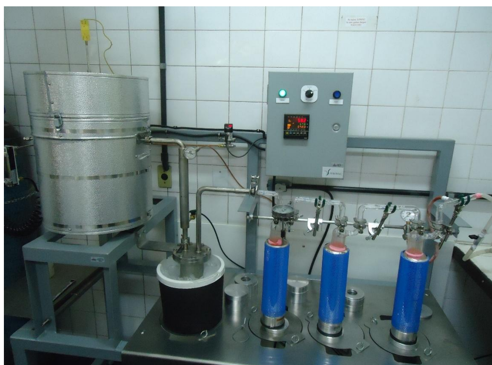
Figura 1. Equipamento utilizado para realização dos experimentos de pirólise a vácuo ( Pyrovac Inc. ).
