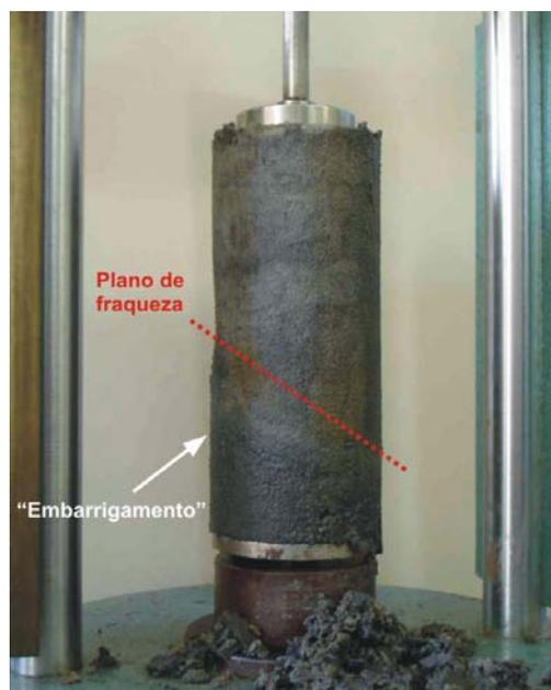
Figura 59: Amostra para ensaio triaxial retirada do tubo amostrador 5 no torno manual, mostrando o plano de fraqueza e o "embarrigamento"
