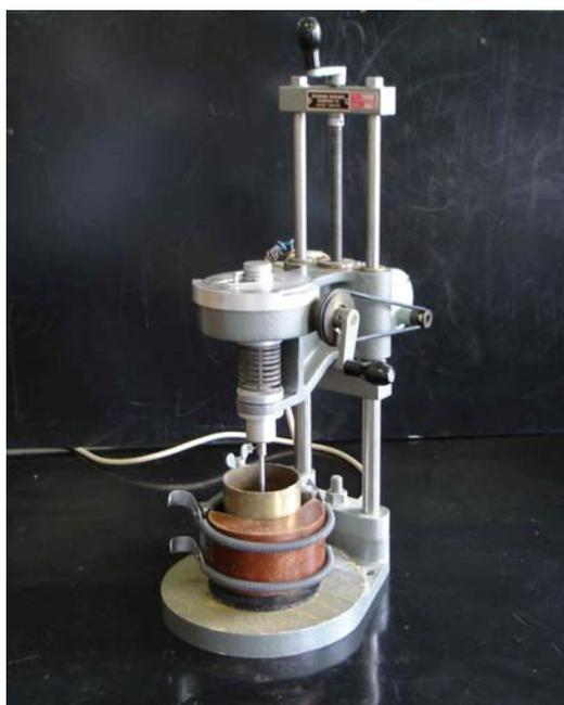
Figura 50: Vista geral do equipamento para ensaio de palheta de laboratório motorizado
