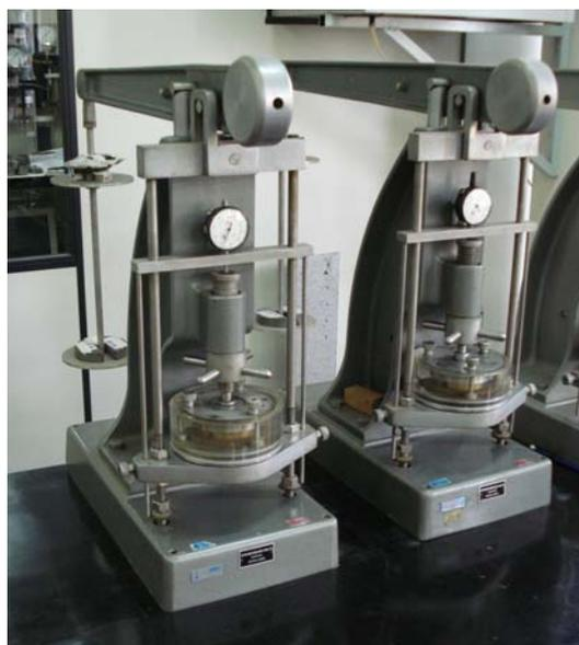
Figura 51: Vista geral das prensas de adensamento utilizadas
