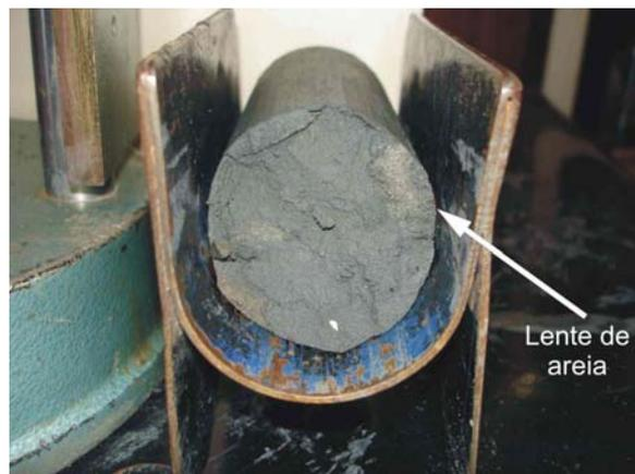
Figura 69: Aspecto do trecho argiloso do tubo 2, de cor cinza escura com mancha clara identificando uma lente arenosa
