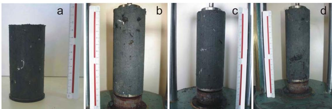
Figura 64: Corpos de prova indeformados do tubo 4 (a) corte 1, (b) corte 2, (3) extrudado 1 e (4) extrudado 2
