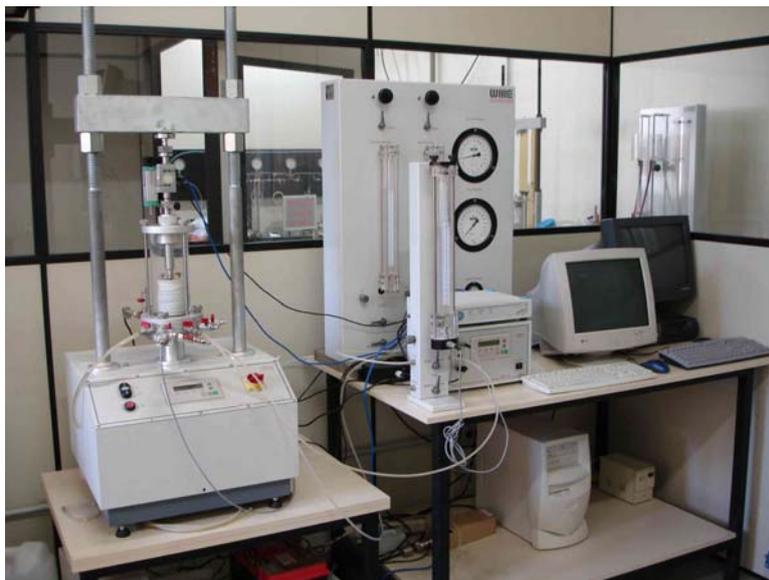
Figura 38: Vista geral da prensa triaxial utilizada para os ensaios triaxiais
