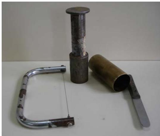
Figura 43: Equipamentos utilizados para a moldagem das amostras amolgadas
