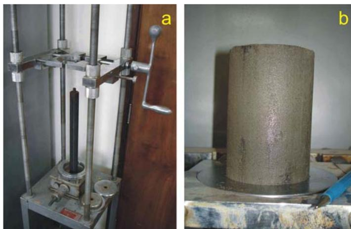
Figura 41: Extrusão do solo (a) extrator de solos e (b) amostra extrudada
