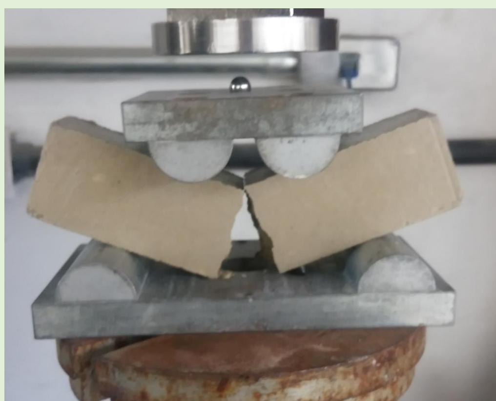
Ruptura do corpo de prova submetido ao ensaio de tração na flexão, realizado conforme a norma ASTM D1635
