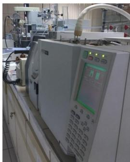
**Figura 3:** GC/MS empregado na análise dos vapores de pirólise.
