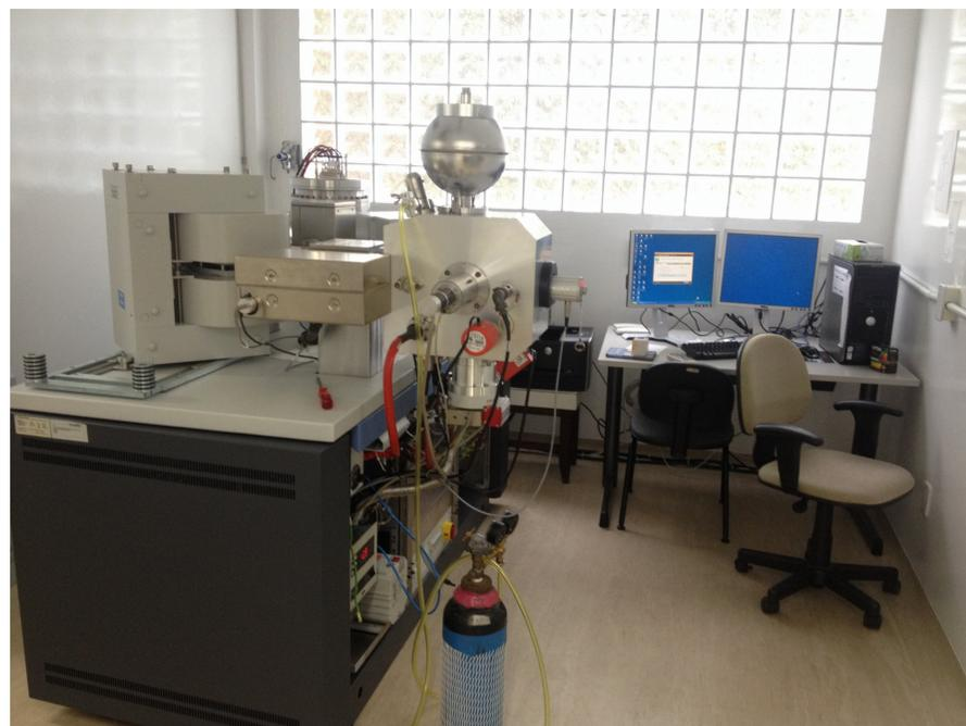
Fig.6: Espectrômetro de massa nos quais as amostras seguiram para análise.
