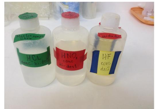
Fig.5: Ácidos utilizados nas amostras para a separação iônica dos ETR's.
