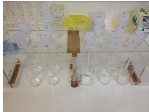
Fig.4: Colunas utilizadas para a separação dos íons dos ETR's Sm e Nd.
