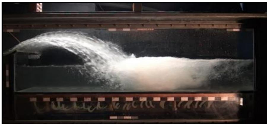
Figura 2 – Modelo reduzido de salto esquí com jato direcionado com incidência de 65° com medições de distribuição de pressão por transdutores de pressão
