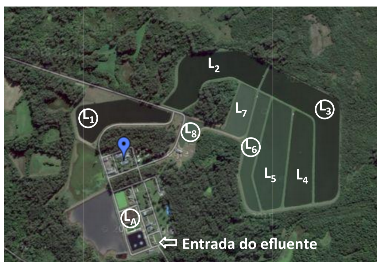
Figura 1. Imagem aérea. L A : Lodo ativado; L 1 -L 8 : lagoas de estabilização em série.
