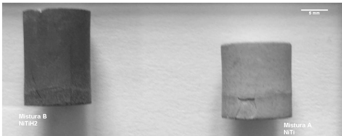
Figura 35: Amostras sinterizadas em forno resistivo a vácuo apresentando boa integridade física.
