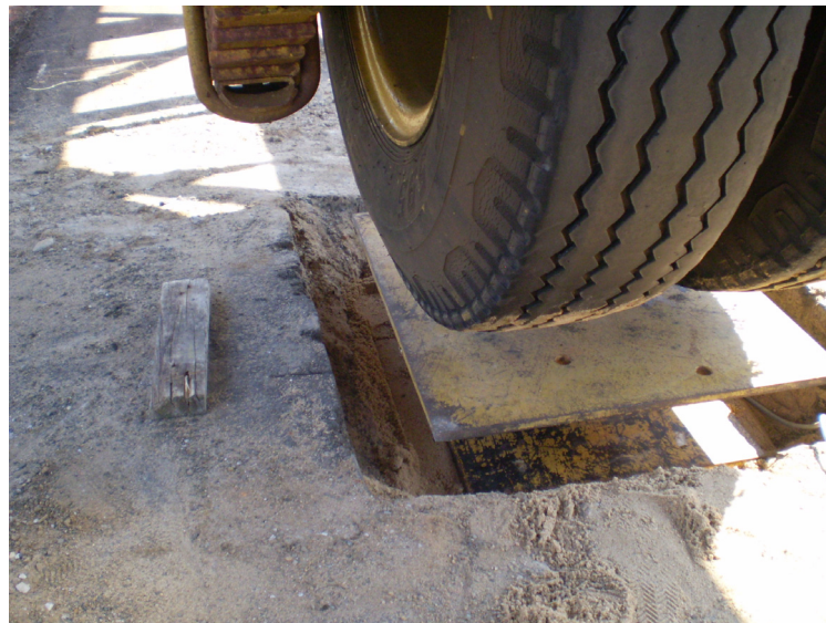
Figura 4.4 – Posicionamento das placas metálicas e da célula de carga
