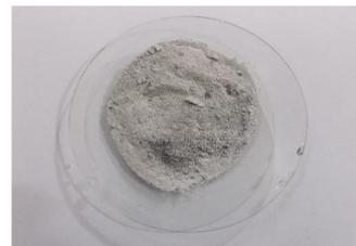
Figura 2 – Após fundida a amostra 1 (A1) resultou em pó
