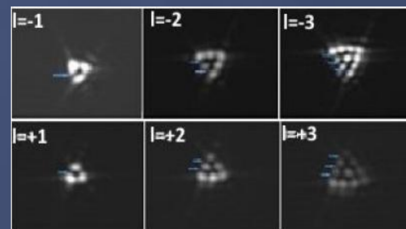
Figura 4: Imagem da difração com a abertura quadrada que indica a carga topológica do feixe gerado.
