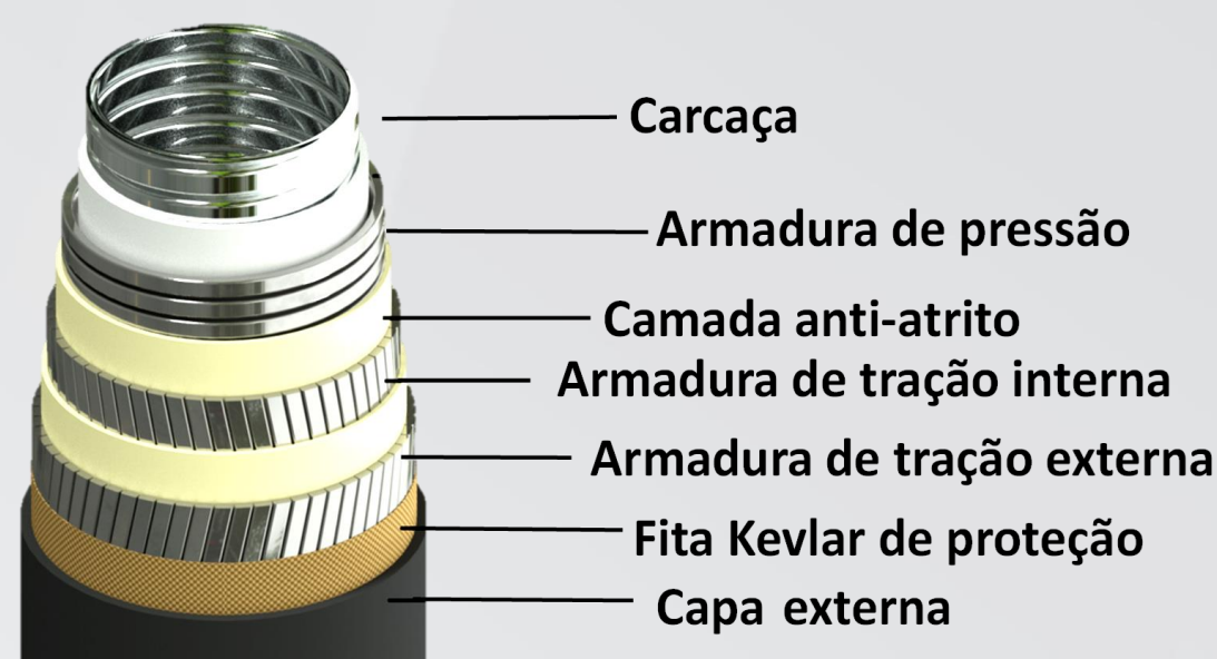
Figura 1: Camadas de um duto flexível.
