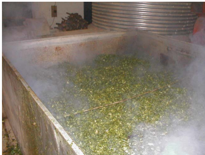
Figura 13 – Processo de desidratação do material triturado.
