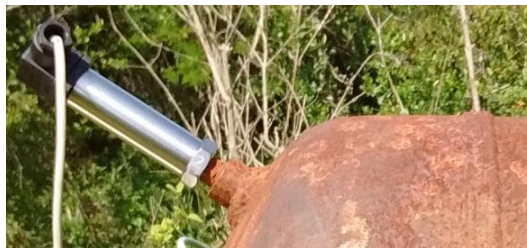
Figura 68 – Transdutor de pressão montado na conexão da câmara hiperbárica
