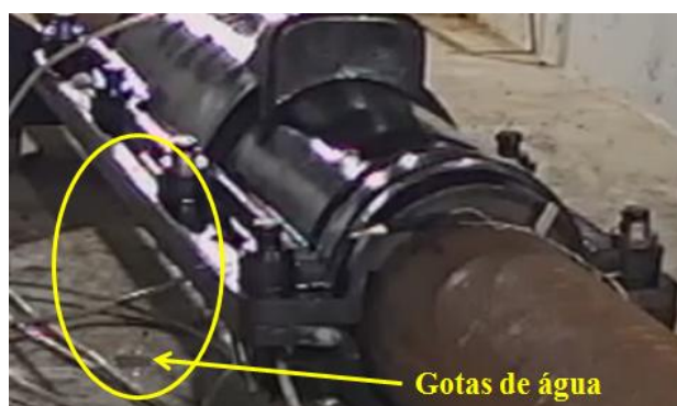
Figura 85 – Imagem da câmera de vídeo no momento que inicia um vazamento na forma de gotas de água
