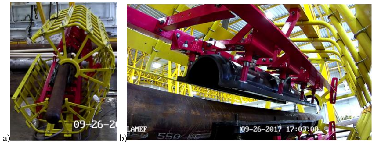
Figura 78 – Imagem da câmera de vídeo durante o acoplamento da ferramenta no duto: a) Câmera de vídeo instalada no lado externo da ferramenta; b) Câmera de vídeo instalada na parte interna da ferramenta
