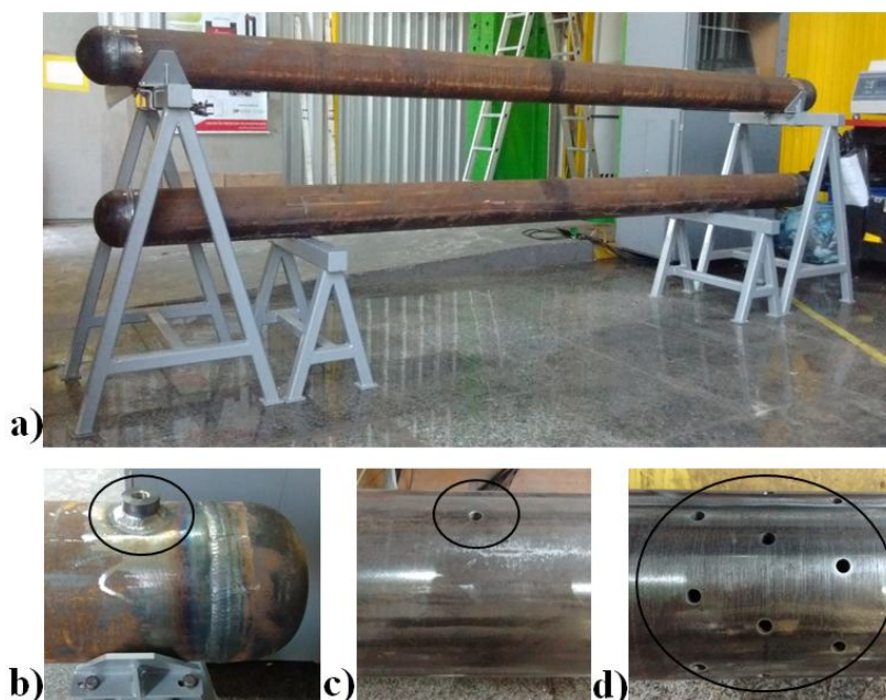
Figura 53 – a) Corpos de prova fabricados para ensaio de pressão interna e externa; b) Detalhe da conexão para entrada de fluido no ensaio de pressão interna; c) Detalhe do defeito na região central do corpo de prova para ensaio de pressão interna; d) Detalhe dos defeitos na região central do corpo de prova para ensaio de pressão externa
