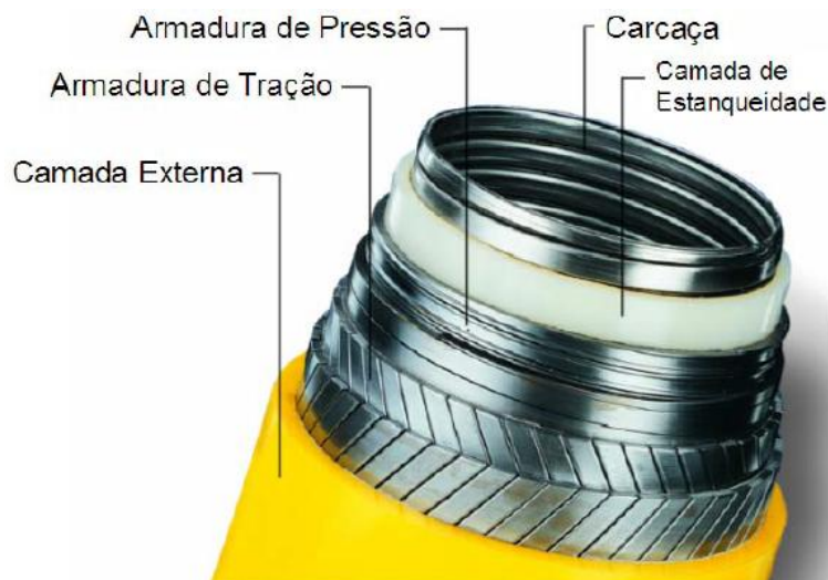
Figura 4 – Configuração típica de um duto flexível do tipo unbonded
