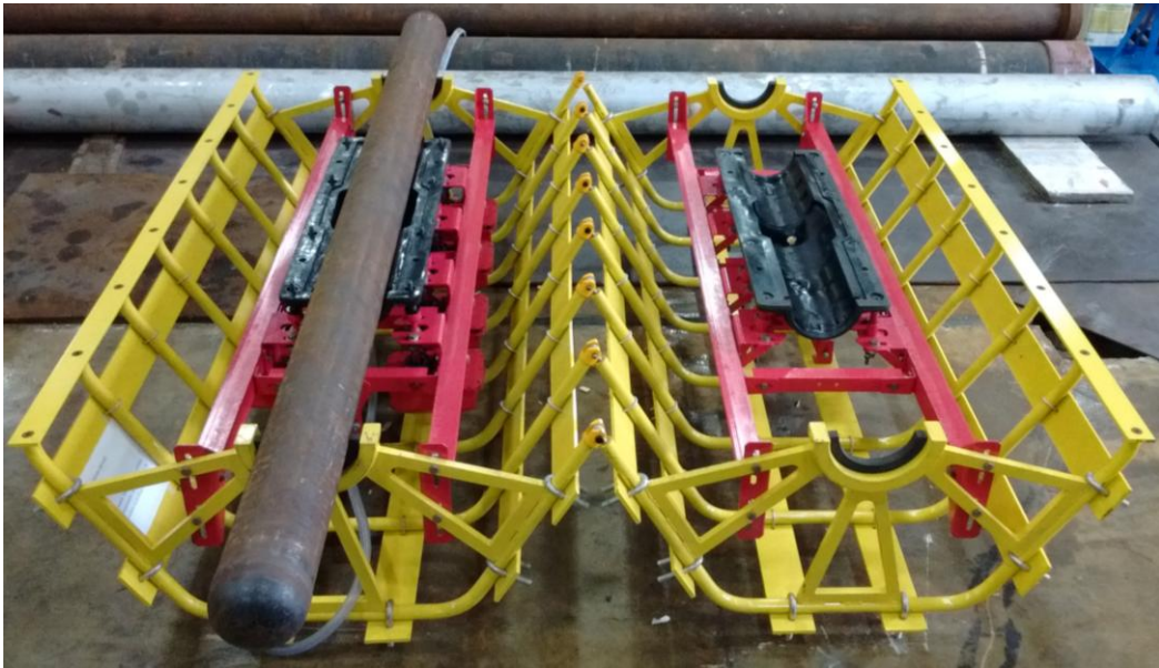
Figura 75 – Ferramenta após a montagem com o clamp e o duto
