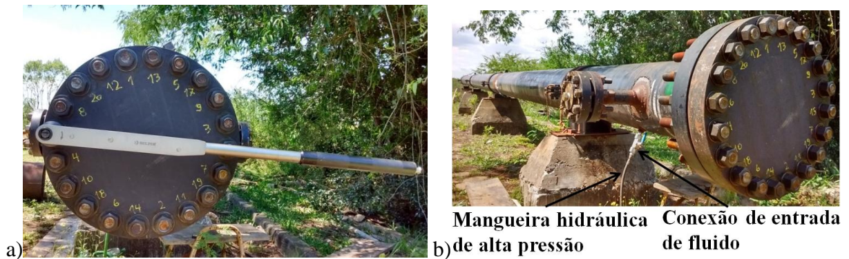
Figura 67 – a) Realização do aperto do flange conforme procedimento e torque recomendado; b) Câmara hiperbárica preparada para a realização do ensaio
