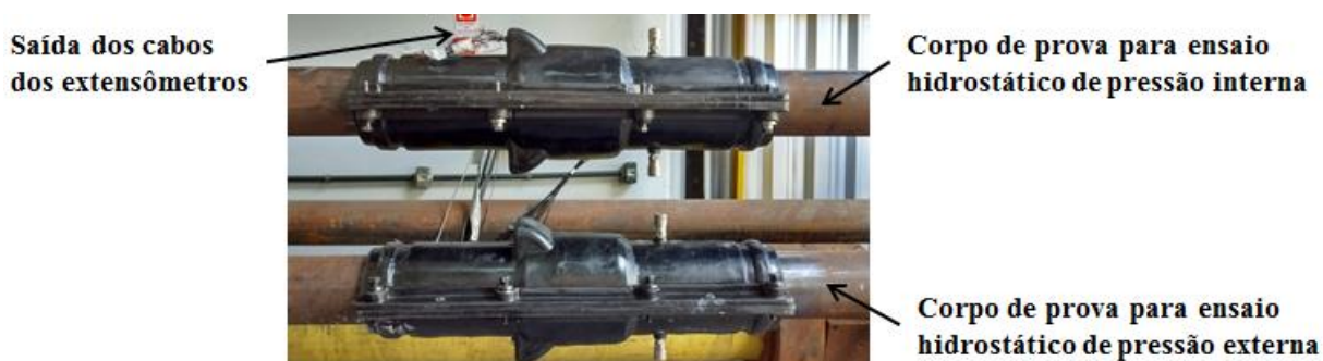
Figura 59 – Corpos de prova após o processo de injeção de resina
