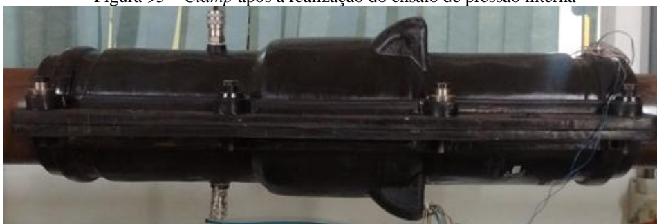
Figura 95 – Clamp após a realização do ensaio de pressão interna
