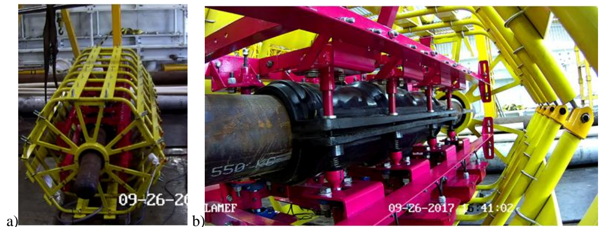
Figura 79 – Imagem da câmera de vídeo após o acoplamento da ferramenta no duto: a) Câmera de vídeo instalada no lado externo da ferramenta; b) Câmera de vídeo instalada na parte interna da ferramenta
