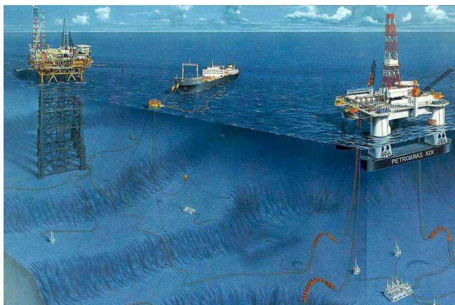
Figura 3 – Sistemas de produção de petróleo offshore , no qual é mostrado da esquerda para a direita: plataforma fixa, unidade flutuante de produção, armazenamento e transferência (FPSO), e plataforma semi-submersível
