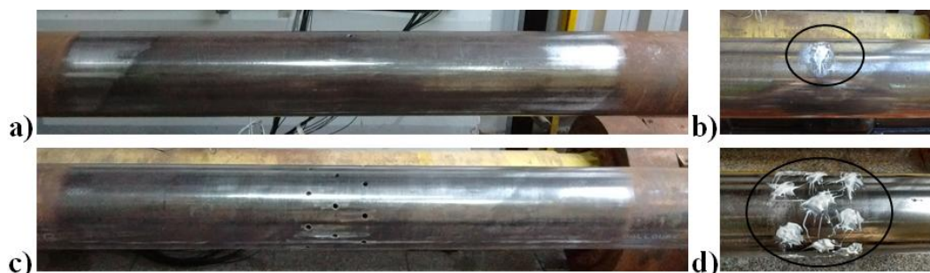
Figura 54 – a) Corpo de prova para ensaio de pressão interna após a preparação da superfície; b) Detalhe do fechamento do furo com resina epóxi no corpo de prova para ensaio de pressão interna; c) Corpo de prova para ensaio de pressão externa após a preparação da superfície; d) Detalhe do fechamento dos furos com resina epóxi no corpo de prova para ensaio de pressão externa
