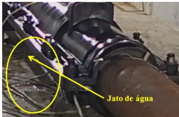
Figura 90 – Imagem da câmera de vídeo no momento que inicia um vazamento na forma de jato de água
