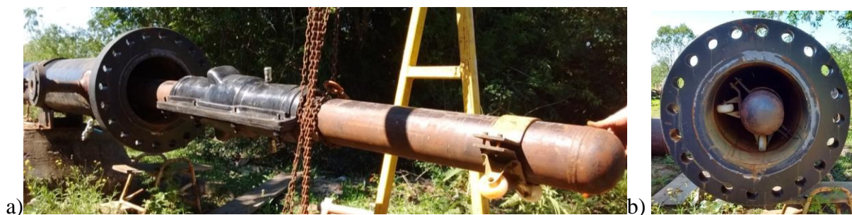
Figura 66 – a) Movimentação do corpo de prova para o interior da câmara hiperbárica; b) Corpo de prova posicionado no interior da câmara hiperbárica
