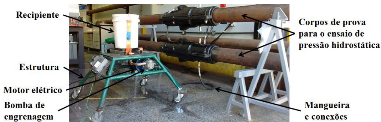
Figura 58 – Aparato para a realização do processo de injeção de resina epóxi no interior do clamp
