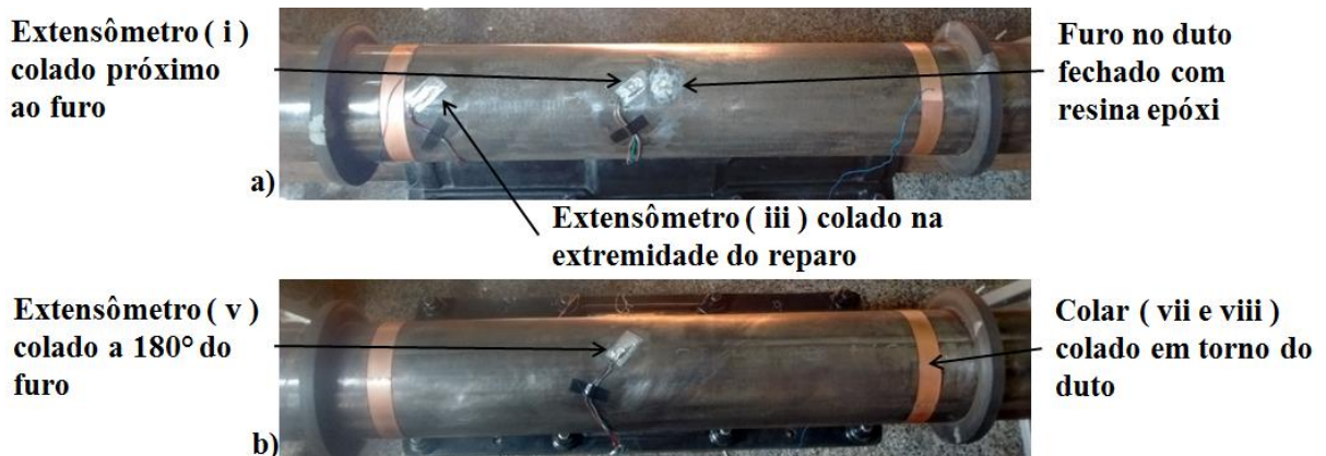
Figura 57 – Instrumentação do duto utilizado no ensaio hidrostático de pressão interna: a) Lado do defeito; b) Lado oposto ao defeito
