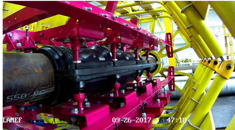
Figura 80 – Imagem da câmera de vídeo após o aperto dos parafusos do clamp
