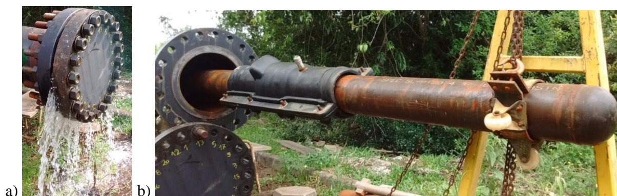
Figura 96 – a) Esvaziamento da câmara hiperbárica; b) Retirada do corpo de prova do interior da câmara hiperbárica
