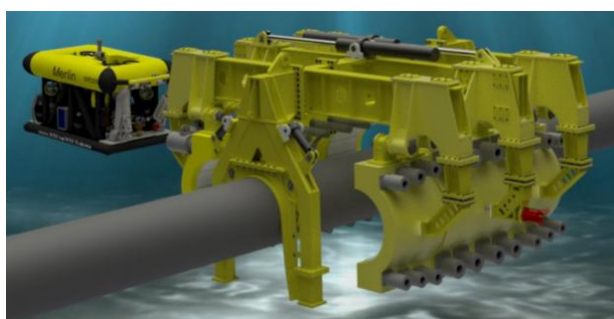
Figura 22 – Ferramenta hidráulica de instalação de braçadeiras de reparo em linhas de transporte de gás
